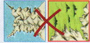
Zo mogen landtegels niet worden geplaatst
